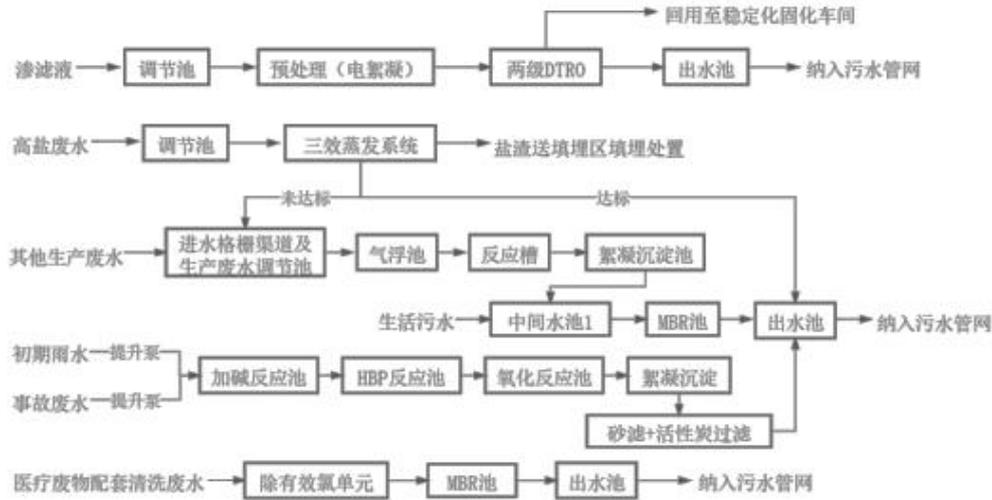
图 4-7 各废水处理工艺示意图
